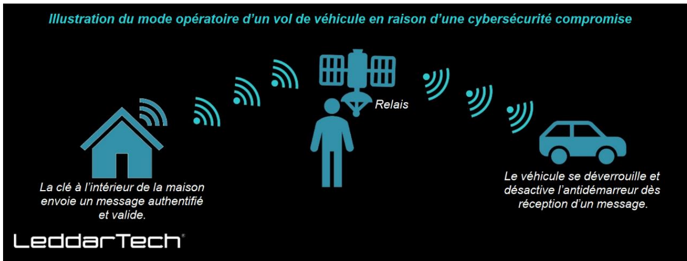
Figure 2 – Illustration d'un vol de voiture résultant de mesures de cybersécurité inadéquates
