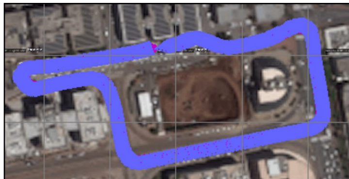
Figure 11 – Localisation de base en vue plongeante (bleu = égomouvement; rose = GNSS comme vérité de terrain)
