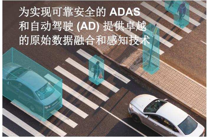
LeddarVision's 以其原始数据传感器融合能力、传感器同步和上采样技术为基础，可实现卓越的目标检测性能和精确的三维 RGBD 环境模型重建。LeddarVision 增加了带时间戳的时间信息（即来自多个数据帧的信息），并对单个目标进行多次测量，从而减少了测量误差并提高了测量精度。在 2019 年至 2021 年间向 nuScenes™ 递交的所有解决方案中，LeddarVision 的 RCF360v2 是用于 3D 目标检测的顶级雷达/摄像头解决方案。LeddarVision 的特点包括：
